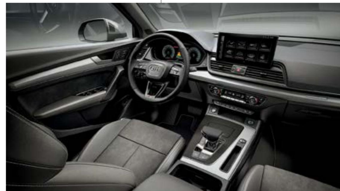
É fácil para o motorista usar o Audi Q5 híbrido plug-in: luzes e faixas laranja indicam o motor a combustão, luzes e faixas verdes acendem quando o motor elétrico está sendo utilizado. Com o tempo, você naturalmente passa a dirigir de forma mais ecológica, poupando combustível e reduzindo as emissões de carbono; o planeta agradece cada pequeno gesto.
