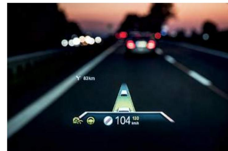
NA PÁGINA AO LADO, O SUV TOTALMENTE ELÉTRICO COM AS MAÇANETAS PRETAS EMBUTIDAS NAS PORTAS. ACIMA, O HEAD UP DISPLAY PROJETADO NO PARA-BRISA COM A VELOCIDADE ATUAL, A VELOCIDADE LIMITADA, A DISTÂNCIA DO CARRO À FRENTE E A PRÓXIMA BIFURCAÇÃO
